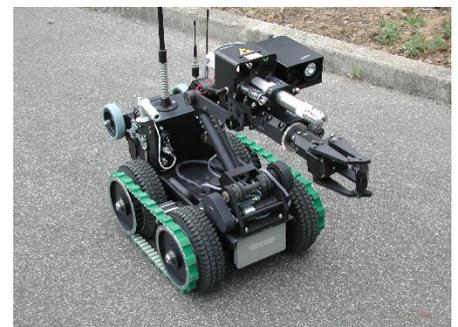
L'unitÉ mobile (robot) communique avec l'unitÉ de tÉlÉcommande (valise) par voie hertzienne, et dispose donc d'un Émetteur vidÉo, avec un sÉlecteur de canal pour la transmission des images camÉras et d'une liaison MODEM radiofrÉquence half duplex pour la transmission des donnÉes numÉriques.
